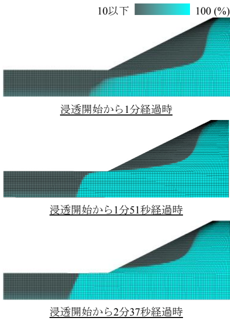
図-4 模型実験の再現解析における飽和度分布
