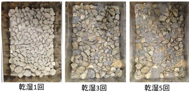
図2 スレーキング率試験中の供試体の様子(泥岩 B)
