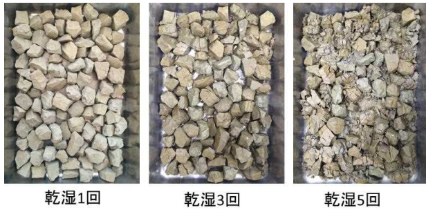
図1 スレーキング率試験中の供試体の様子(泥岩 A)
