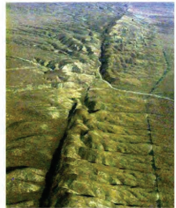
写真 1 サンドレアス断層沿いに発達したリーデルせん断帯 1)
