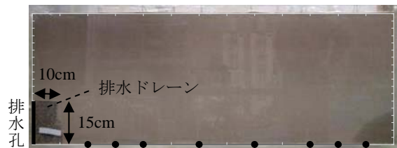
図 1 基礎地盤のみの実験の初期状態 (Case_1)
